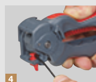
4 Insertion du conducteur et sertissage
